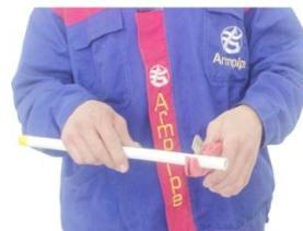
بعد از برش لوله حتما باید دهانه داخلی لوله به وسیله ابزار کالیبراتور (برقو) پلیسه گیری شود. برقو علاوه بر پلیسه گیری فرم دایره ای به دهانه لوله میدهد که باعث سهولت قرار گیری اتصال به داخل لوله میشود. ضمناً جهت روان کاری هنگام کار با ابزار برقو (کالیبره) از مایع روان کننده استفاده میشود و استفاده از روغن و گریس ممنوع است.
