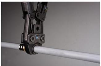
دستگاه پرس لوله ۵ لایه هیدرولیک برای پرس کردن فیتینگ‌های پرسی لوله‌های تلفیقی استفاده می‌شود. این دستگاه دردو نمونه دستی و هیدرولیک طراحی شده است و دارای ۴ فک کشویی بوده که به سرعت و سهولت قابلیت تعویض دارند. نیروی پرس توسط پمپ هیدرولیک دستی ایجاد شده تا بیشترین نیرو جهت پرس کردن فیتینگ‌ها به لوله ایجاد شود.
